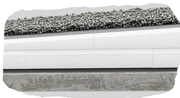
betonsku (AB) ploču postavila parna brana, koja ima funkciju sprečavanja prodora pare i vlage u termoizolaciju, pristupa se postavljanju termoizolacije. Za ovu namenu se koriste
